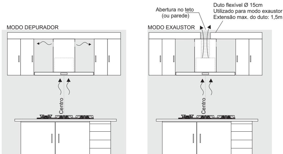
Para fixação, centralizar a linha de centro da coifa com o centro do fogão/cooktop. Com uma trena, achar a altura entre o fogão e a base da coifa, conforme indicado neste manual (65 a 80 cm). Utilizar o gabarito de fixação e marcar a posição dos furos para fixação da coifa. Verificar se a altura da coifa até o teto não é superior a altura máxima do duto de inox.
