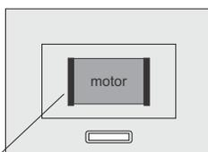
Inserir o pino do filtro de carvão na cavidade retangular na parte superior da lateral do motor seta A.
