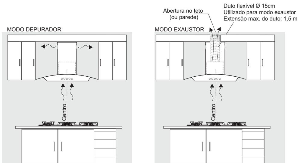
Para fixação, centralizar a linha de centro da coifa com o centro do fogão/cooktop. Com uma trena, achar a altura entre o fogão e a base da coifa, conforme indicado neste manual (65 a 80 cm). Utilizar o gabarito de fixação e marcar a posição dos furos para fixação da coifa. Verificar se a altura da coifa até o teto não é superior a uma altura máxima do duto de inox (vide página 8).
