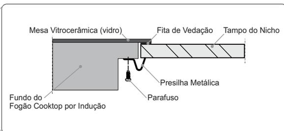
Detalhe instalação da presilha metálica
