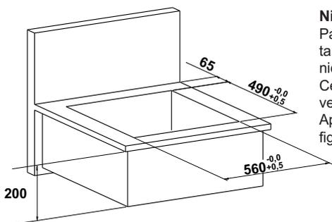
**Nicho:** recorte no móvel para o embutimento do produto. Para instalar o fogão cooktop por indução, verifique se o tampo está nivelado e em seguida posicionar o cooktop no nicho.
